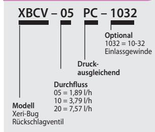
Spezifikationen und Modelle der Xeri-Bug-Rückschlagventiltropfer
