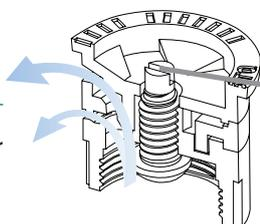
Edelstahlschraube zur Einstellung von Durchfluss und Wurfweite
