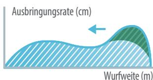
Verbesserte Verteilungsgenauigkeit durch dynamischen Strahlunterbrecher bei Niederdruckanwendungen und ortsfesten Anlagen
