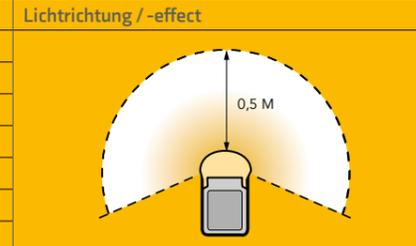
Einbaustrahler werden meist als Orientierungslicht eingesetzt. In der untenstehenden Ansicht können Sie die verschiedenen Einbaustrahler einfach vergleichen und die richtige Leuchte auswählen.
